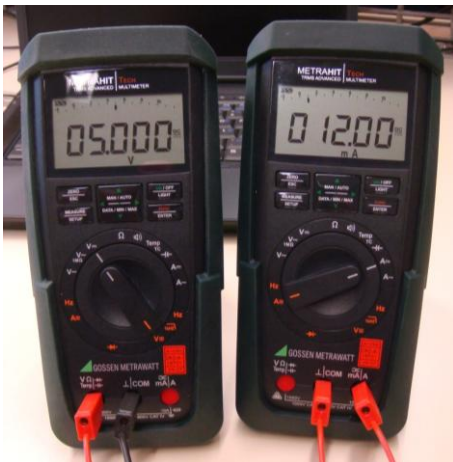
Die Messgeräte: digitale Multimeter
