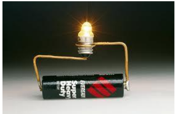
Einfachster elektrischer Stromkreis
